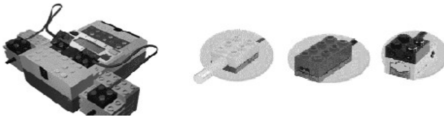
Εικόνα 1: Μικροϋπολογιστής-τούβλο RCX, κινητήρες, αισθητήρες θερμοκρασίας, φωτός και αφής.
